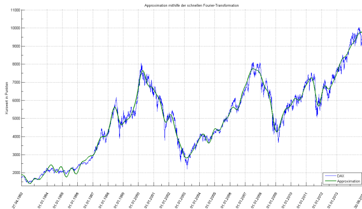
Abbildung 1: Approximation (grün) des deutschen Aktienindex (blau) mithilfe der schnellen FOURIER-Transformation und den 64 betragsmäßig größten Koeffizienten
